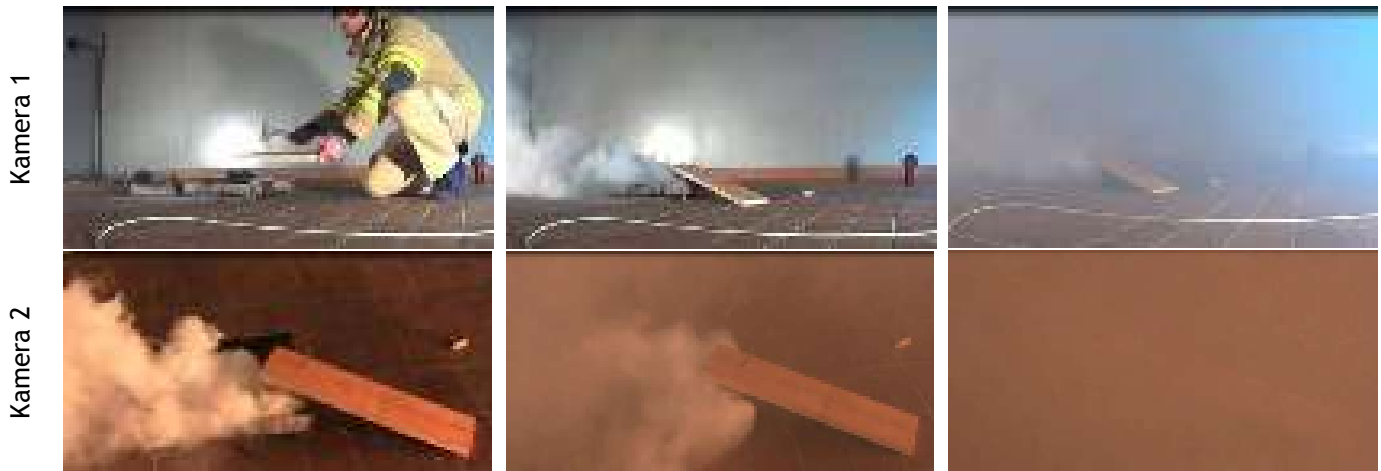
Beschädigung und unmittelbar einsetzende Rauchentwicklung.
