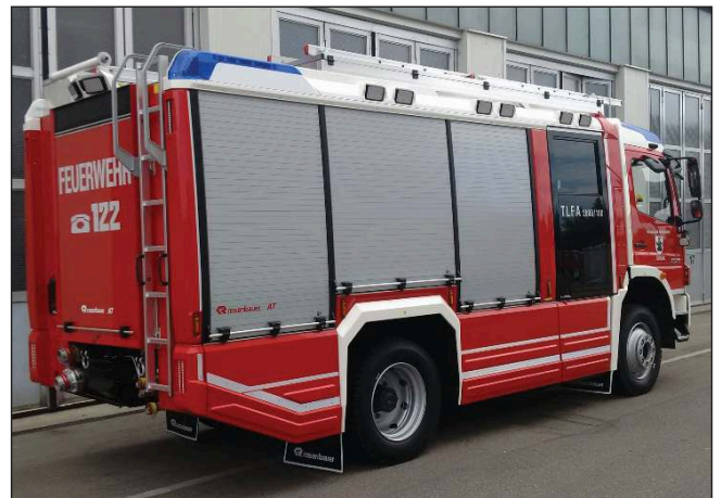
Fahrgestell: Mercedes Atego 1629 AF Abnahme: 01.07.2014 bei der Firma Rosenbauer
