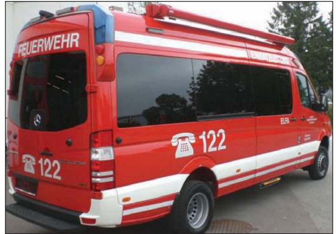
Fahrgestell: Mercedes Sprinter 519 CDI 4x4 Abnahme: 03.09.2014 bei der Firma Dlouhy in Tulln
