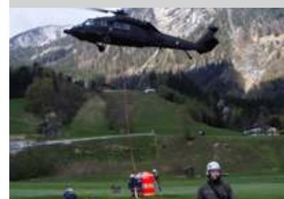
**Flughelferweiterbildung:** Befüllen des 3000l Löschbehälters für den Black Hawk.
