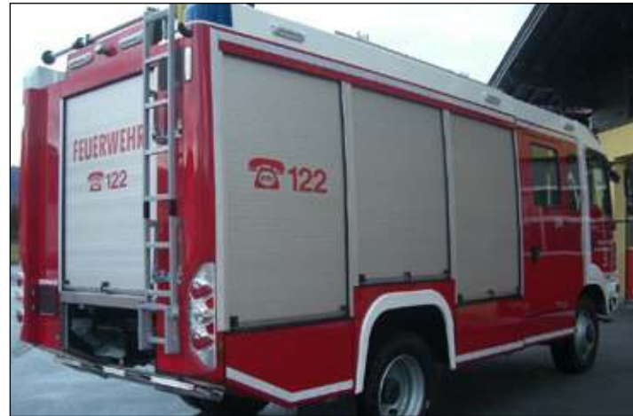
Fahrgestell: MAN 13.250 4 x 4 Abnahme: 11.01.2012 bei der Fa. Seiwald
