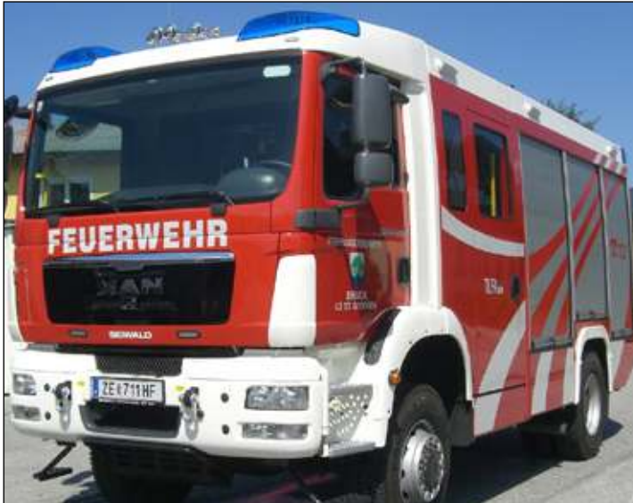
Taktische Bezeichnung: TLFA 3000 Aufbaufirma: Fa. Seiwald
