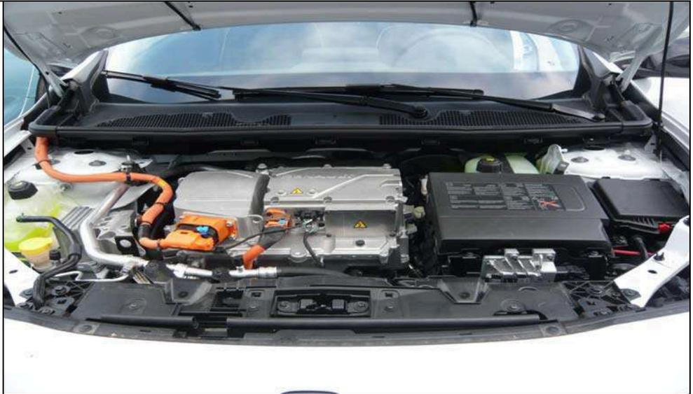
Die orange Farbe der 400V-Kabel bedeutet nicht, dass es sich um feuerresistente Kabel handelt.
