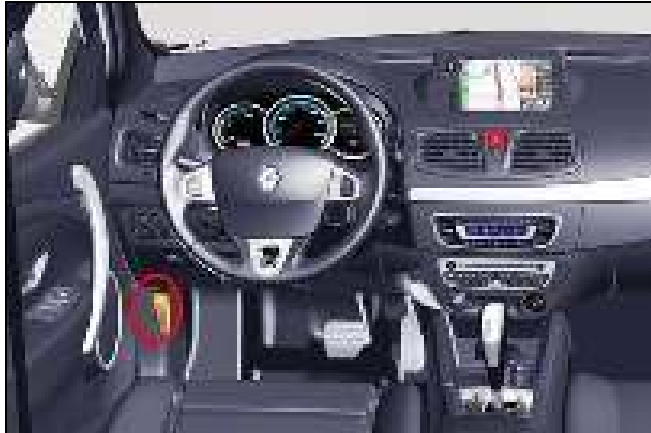
Öffnungsbetätigung für die Motorhaube im Fahrgastraum
