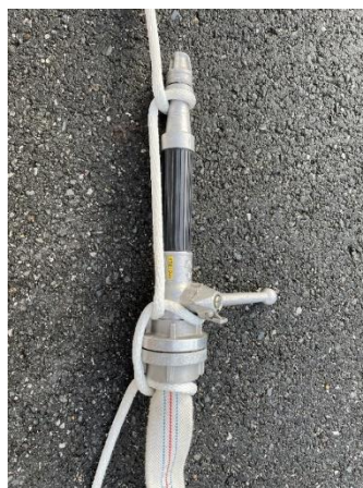
Strahlrohraufzug: Kreuzklink gelegt mit einem halben Schlag an C-Strahlrohr mit Schlauch
