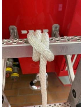
Kreuzklink (Mastwurf) gestochen (z.B.: an der Sprosse einer Aufstiegsleiter, ...)
