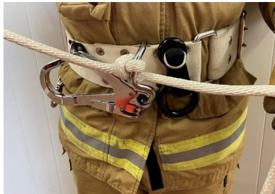
Halbmastwurf gestochen (an der Öse des Feuerwehrgurtes)
