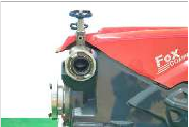
Abb. E05: Richtige Knaggenstellung TS-Ausgang (ÖBFV)
