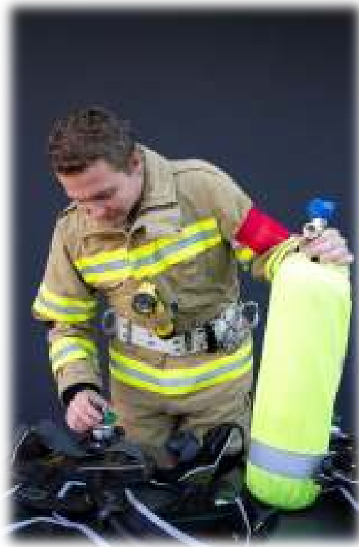
Kontrolle des O-Ringes, dieser darf nicht berührt werden.
