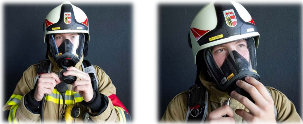
Anschließen des LA, auf festen Sitz überprüfen
