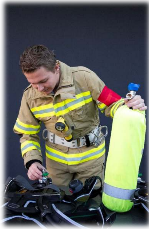
Kontrolle des O-Ringes, dieser darf nicht berührt werden.
