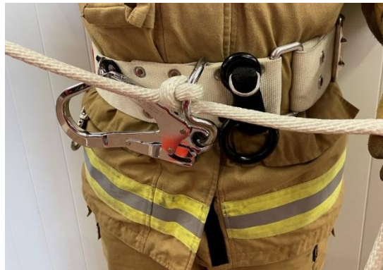
Halbmastwurf gestochen (an der Öse des Feuerwehrgurtes)
