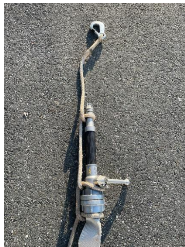
Strahlrohraufzug: Kreuzklink gelegt mit einem halben Schlag an C-Strahlrohr mit Schlauch, Strahlrohr muss geschlossen sein
